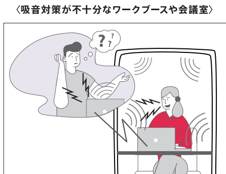
余計な反響音を拾ってしまい、声が聞き取りにくい。無意識に必要以上に大きな声で話してしまう。
